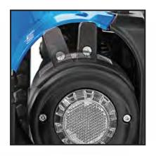
An den Motoren können die Bremsen einzeln gelöst werden, wodurch der Rollstuhl manuell bewegt werden kann
